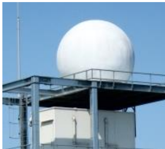
MPレーダー（降雨と風速の三次元構造）
