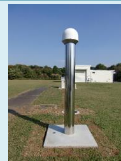
GNSS受信機 (写真: 観測部提供)
